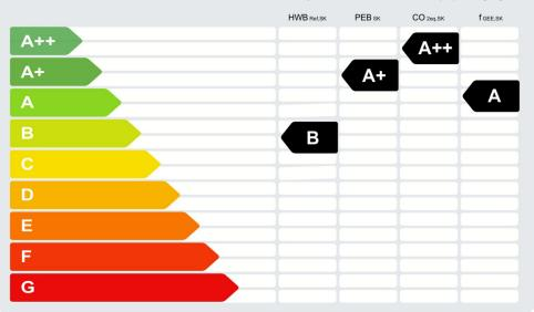
HWBrad: Der Referenz-Heizwärmebedarf ist jene Wärmemenge, die in den Räumen bereitgestellt werden muss, um diese auf einer normativ geforderten Raumtemperatur, ohne Berücksichtigung allfälliger Erträge aus Wärmerückgewinnung, zu halten.
