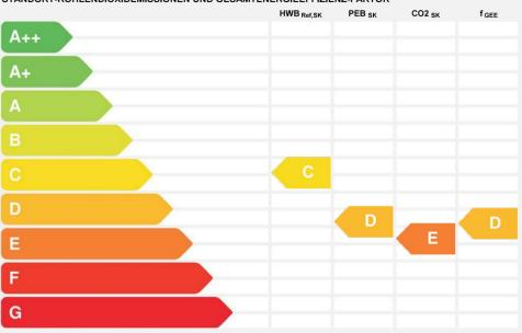
HWB net: Der Referenz-Heizwärmebedarf ist jene Wärmemenge, die in den Räumen bereitgestellt werden muss, um diese auf einer normativ geförderten Raumtemperatur, ohne Berücksichtigung allfälliger Erträge aus Wärmerückgewinnung, zu halten.
