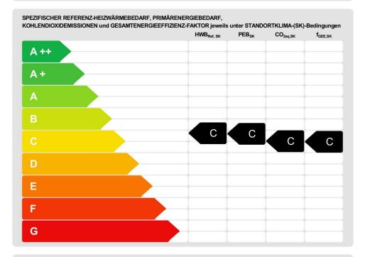
HWB<sub>nu</sub>: Der Referenz-Heizwärmebedarf ist jene Wärmemenge, die in den Räumen bereitgestellt werden muss, um diese auf einer normativ geforderten Raumtemperatur, ohne Berücksichtigung allfälliger Erfräge aus Wärmerückgewinnung, zu halten.
