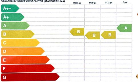
HWB: Der Helzwärmebedarf beschreibt jene Wärmemenge, welche den Räumen rechnerisch zur Beheizung zugeführt werden muss.
