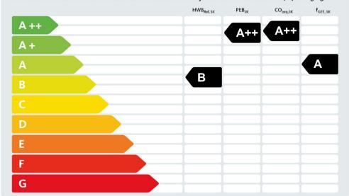
$HWB_{Ref}$ . Der Referenz-Heizwärmebedarf ist jene Wärmemenge, die in den Räumen bereitgestellt werden muss, um diese auf einer normativ geforderten Raumtemperatur, ohne Berücksichtigung allfälliger Erträge aus Wärmerückgewinnung, zu halten.
